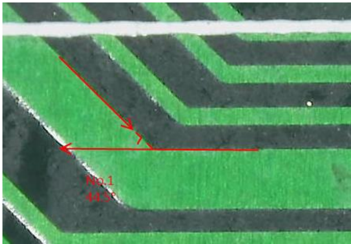
図 5-22 補助角度測定の例
