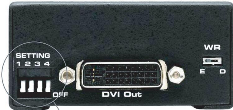
プリプログラムEDIDの選択には**SETTING** DIPスイッチの1~3番を使用します。スイッチの上側の位置がON、下側がOFFです。
